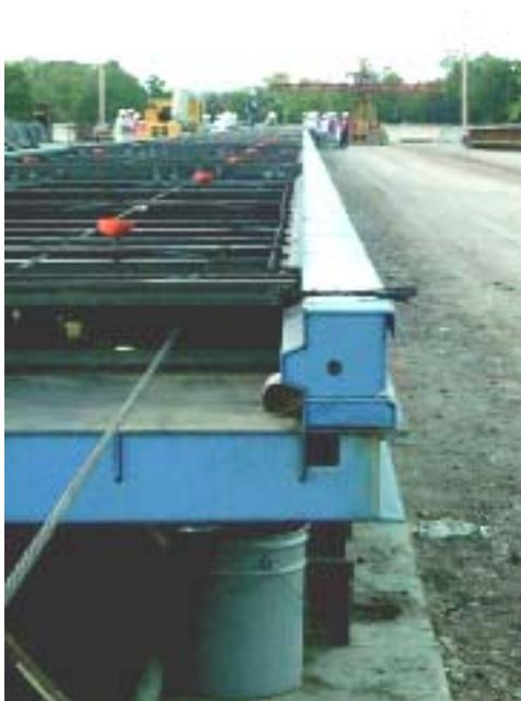
Coffrage des panneaux à l'usine de préfabrication
