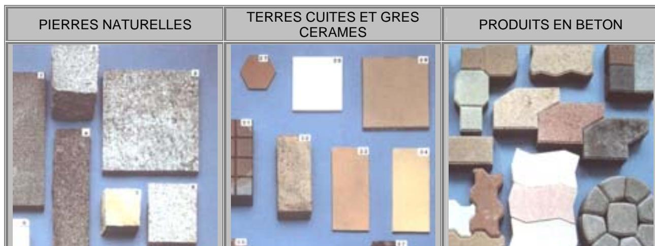
*Figure 2 : famille de revêtements modulaires pour couches de surface de chaussées composite type 2*
